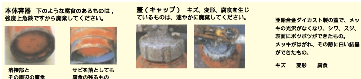
図1 錆の発生した消火器
