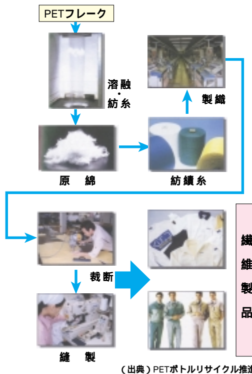
図2 PETフレークのリサイクル製造過程
