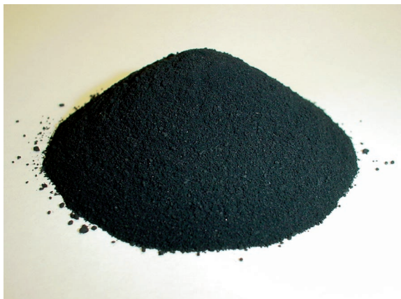
図 15-6 廃タイヤ燃え殻の吹付用モルタルの着色剤利用
