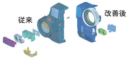
図 10-1 ビデオカメラのフロントカバーとマイクカバーの一体化 ビデオカメラの易解体設計の一例。
